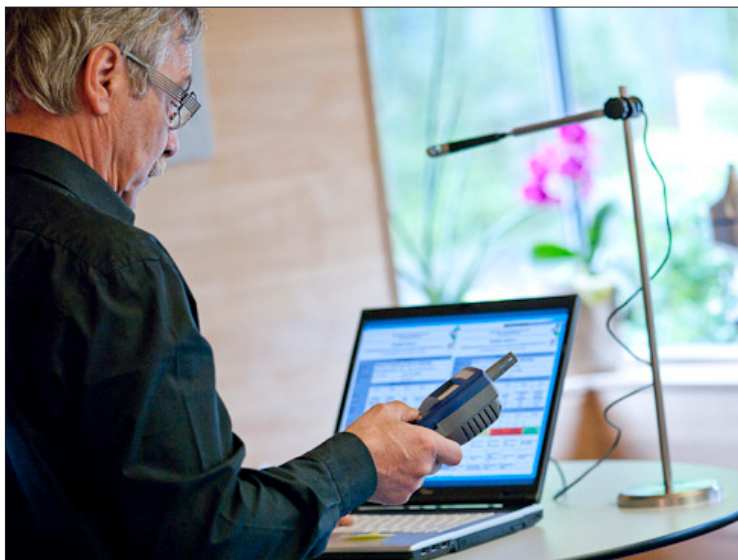
Ludwig Rüdissers bei der Arbeit: Mit Hilfe aufwendiger Technik misst er z.B. die Behaglichkeitsparameter der Raumlufte.
